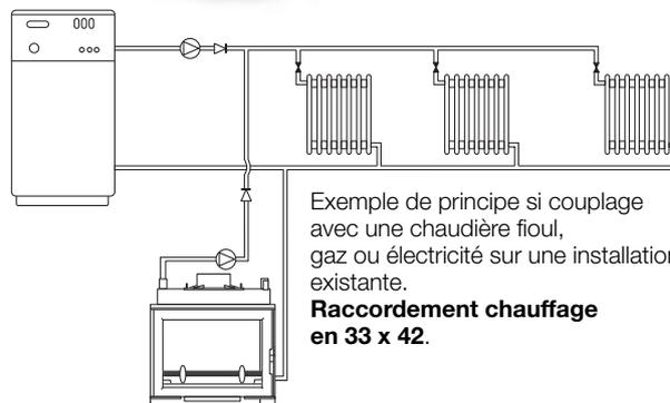
Exemple de principe si couplage avec une chaudière fioul, gaz ou électricité sur une installation existante.
